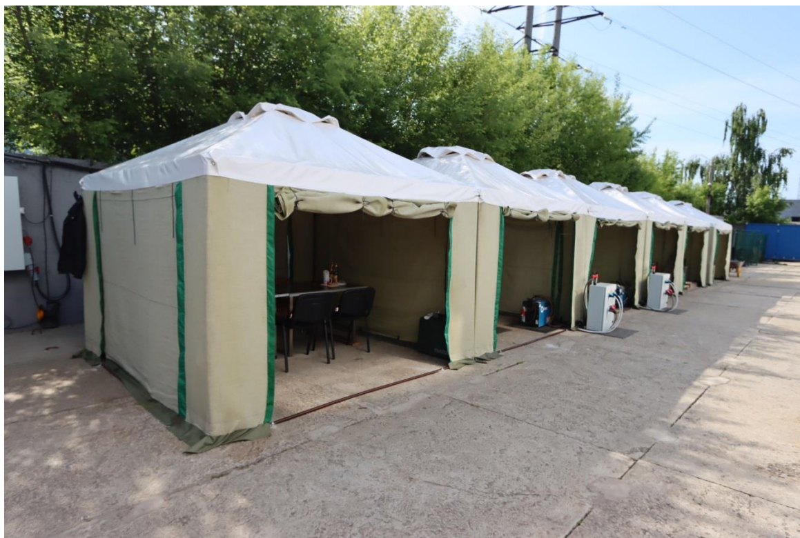
Сварочные палатки (6 шт.), оснащенные вытяжными вентиляторами, светодиодными прожекторами, сварочными кронштейнами
