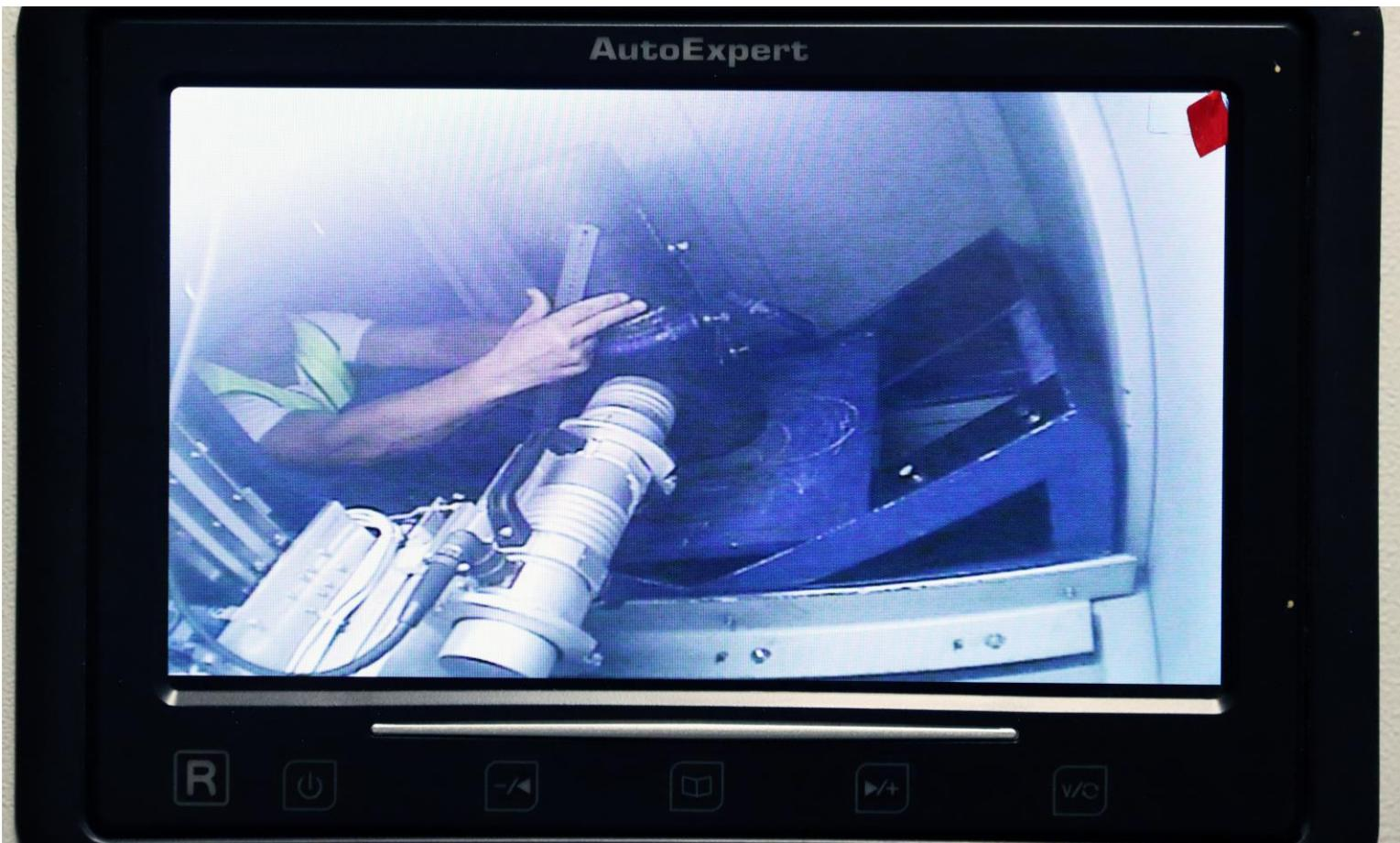
**Размещение Соискателями КСС внутри камеры радиационной защиты «АРИОН-14.10.10.08» модульного блок-контейнера «Испытательного центра», установка фокусного расстояния до рентгенаппарата**
