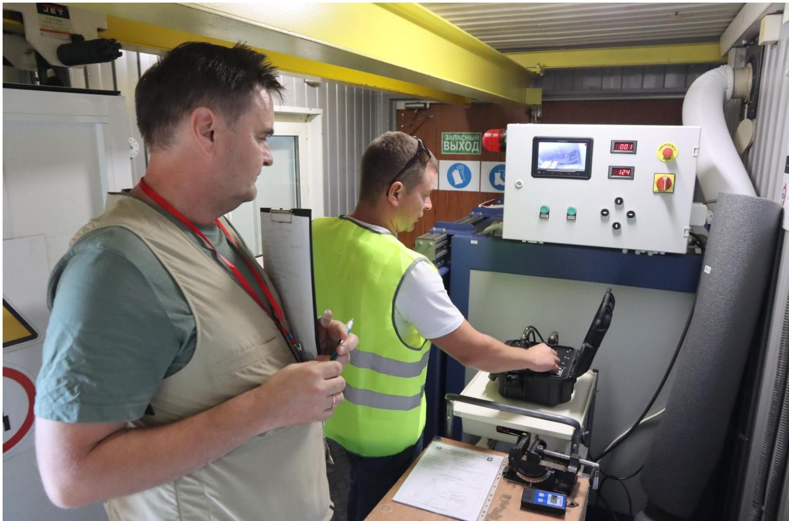
**Проверка Техническим экспертом практических навыков Соискателей по проведению экспонированию при рентгенографическом контроле КСС в камере радиационной защиты «АРИОН-14.10.10.08» модульного блок-контейнера «Испытательного центра»**
