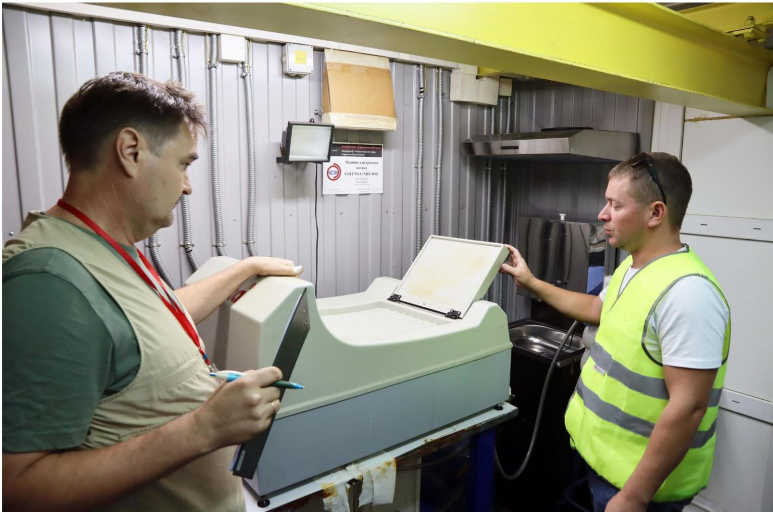
**Проверка Техническим экспертом практических навыков Соискателей по проявке, закреплению, сушке рентгенографической пленки в проявочной машине «COLENTA INDX 900 E»**
