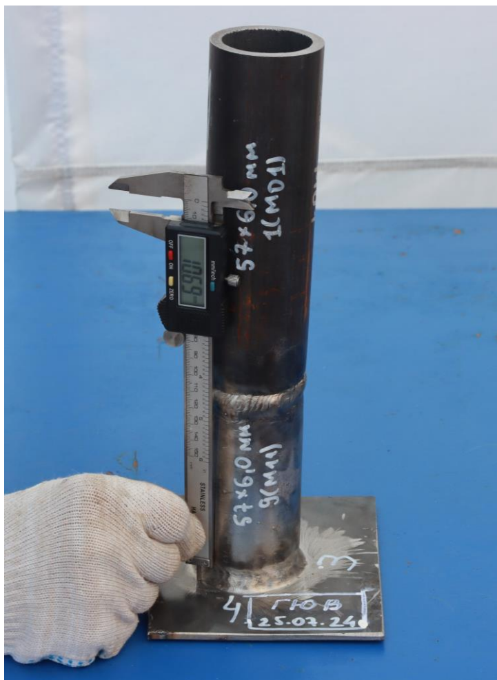
Визуальный и измерительный контроль (ВИК) кольцевых стыковых и тавровых соединений сварных конструкций, выполненных на практическом этапе профессионального экзамена
