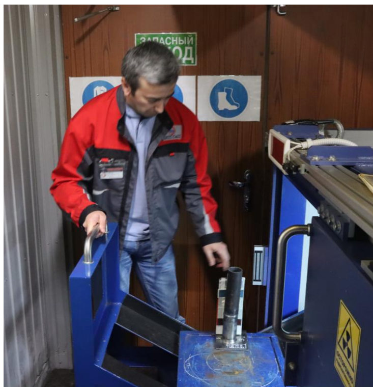
Рентгенографический контроль (РК) кольцевых стыковых и тавровых соединений сварных конструкций, выполненных на практическом этапе профессионального экзамена
