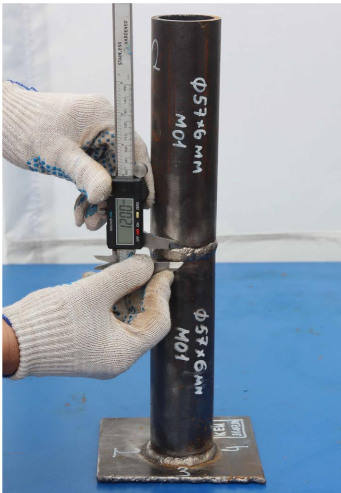
Визуальный и измерительный контроль (ВИК) кольцевых стыковых и тавровых соединений сварных конструкций, выполненных на практическом этапе профессионального экзамена
