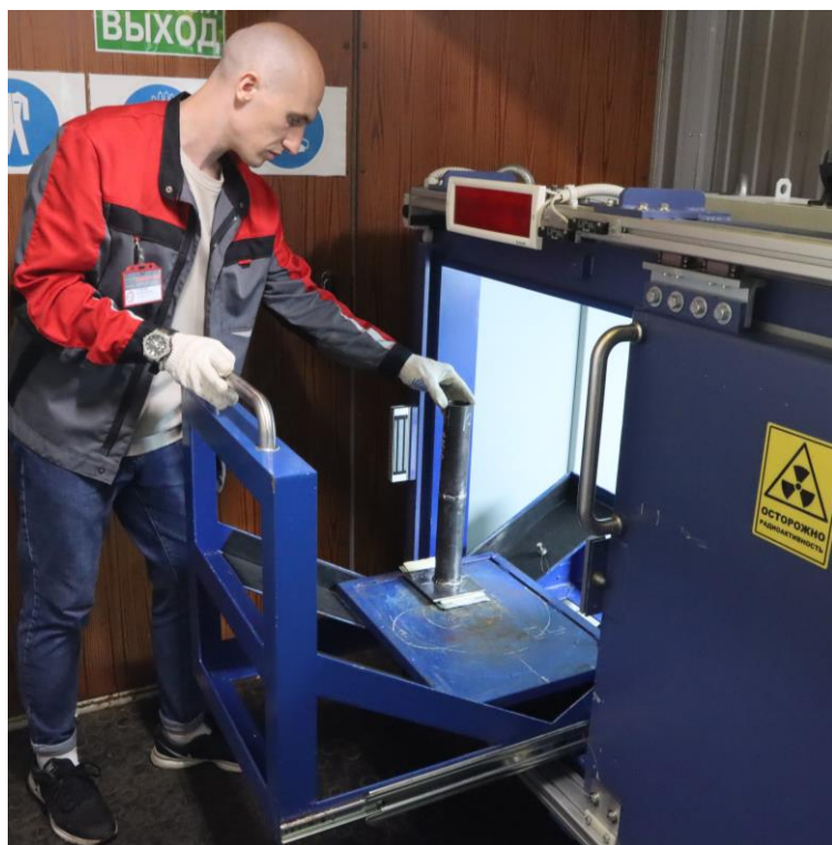
Рентгенографический контроль (РК) кольцевых стыковых и тавровых соединений сварных конструкций, выполненных на практическом этапе профессионального экзамена
