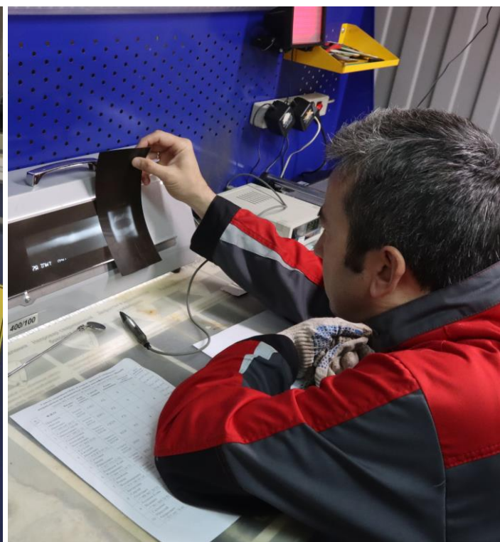
Рентгенографический контроль (РК) кольцевых стыковых и тавровых соединений сварных конструкций, выполненных на практическом этапе профессионального экзамена
